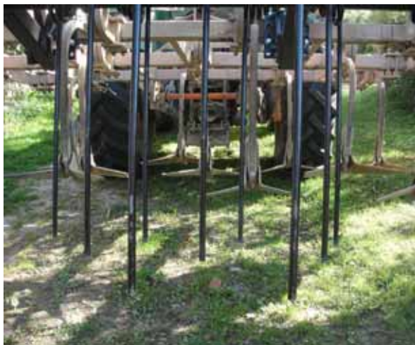
La sarcluse de J. Pousset travaille à plat avec un double recouvrement des socs pour éliminer toute végétation, surtout les vivaces. La herse étrille a pour objectif de finir de remonter les racines et de préparer le lit de semences.
